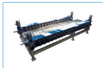
Unité de formage à galets pour système de bride intégrée
